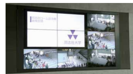
9面マルチスクリーン 壁面に設置されているマルチビジョンは、1画面が55インチのスクリーン9画面で構成されており、複数の映像をさまざまなレイアウトで投影できます。
